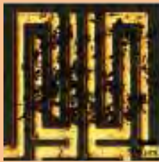
บริเวณตอบสนองของเซนเซอร์จากคาร์บอนนาโนทิวบ์ และการตอบสนองต่อไอระเหยแอมโมเนียที่ความเข้มข้นต่าง ๆ
